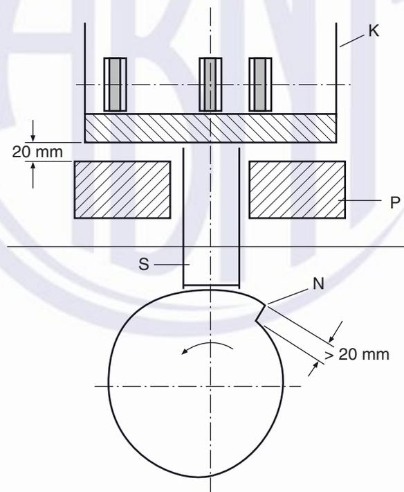
Figura 1 – Equipamento para ensaio de vibração
