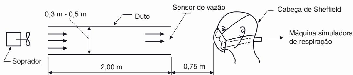
Figura 11 – Esquema da disposição de parte do equipamento para ensaio de CO<sub>2</sub>
